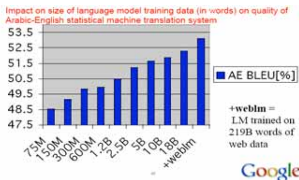
图 3 英语-阿拉伯语机器翻译系统的质量与训练数据规模的关系
